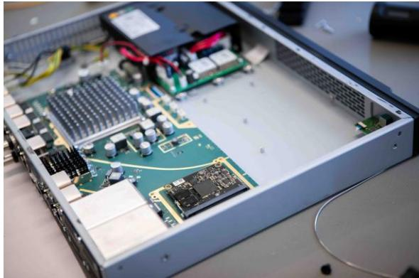
Die Integration von Spectera in Rundfunkproduktions-Workflows wird durch ein Merging ZMAN-Audionetzwerkmodul erleichtert. So kann die Base Station gemäß ST 2110-30 eingesetzt werden.
